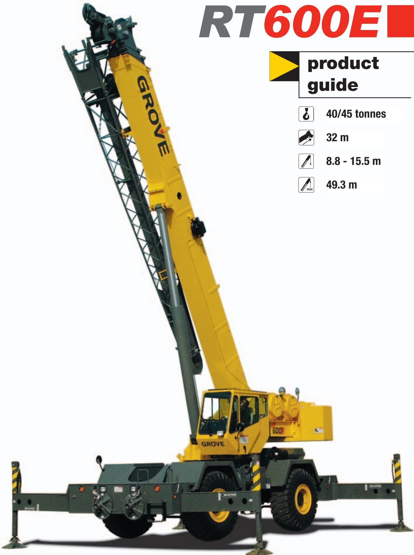
Rough Terrain Crane • Geländekran • Grue Tout-Terrain
