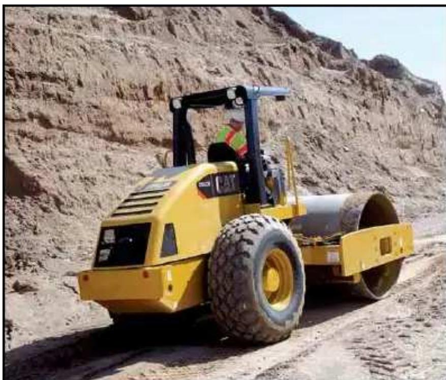
**Sistema de propulsión.** El sistema de propulsión de dos bombas, de acción exclusivamente a esta función, acciona los motores del tambor y de las ruedas traseras, independientemente. Aunque el tambor o las ruedas comenzaran a patinar, la máquina mantendría su fuerza de tracción porque siempre habrá caudal hidráulico suficiente para el motor que no patina. Esto resulta especialmente útil cuando se trabaja en suelos blandos o de materiales sueltos.
