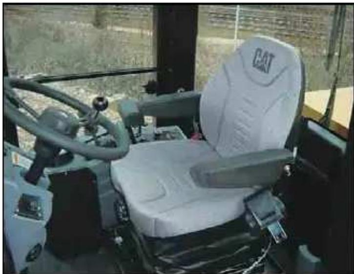
**Una sola palanca.** Una sola palanca permite controlar los sistemas vibratorio y de propulsión con facilidad y sin esfuerzo. Para mayor comodidad del operador, la palanca tiene un apoyo para la muñeca, almohadillado y ajustable.
