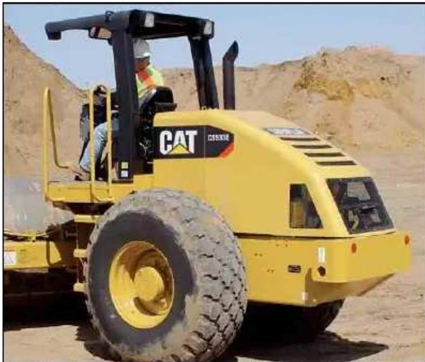
**Visibilidad.** La visibilidad del operador hacia atrás y sobre las ruedas es excepcional. La inclinación del capó del motor permite al operador ver cualquier obstáculo de 1 metro de altura, situado 1 metro detrás de la máquina. Como la visibilidad frontal también es excelente, la
