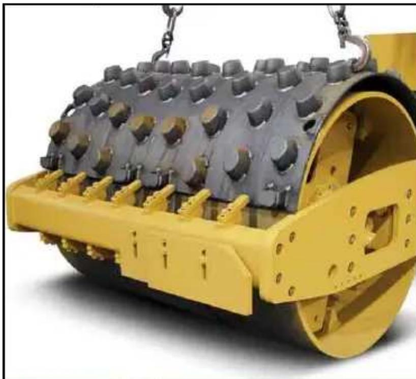
**Versatilidad y utilización.** El revestimiento de pata de cabra aumenta la versatilidad y la utilización de la máquina y proporciona una solución sencilla y de excelente relación coste-eficacia en aquellos trabajos de compactación que requieran utilizar un tambor liso y un tambor de pata de cabra.
