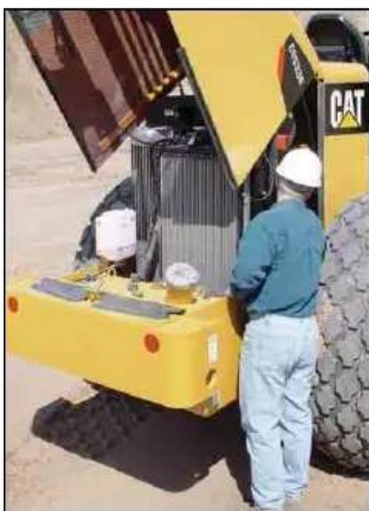
*Levantando el capó de fibra de vidrio del motor se accede cómodamente al motor y al sistema de refrigeración. Todos los puntos de servicio son accesibles desde el suelo y están agrupados en uno de los lados de la máquina.*
