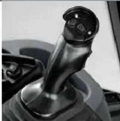
El interruptor en la palanca permite el control fácil de los accesorios accionados hidráulicamente. Encienda y apague, o mantenga oprimido el interruptor para control momentáneo. Los interruptores de control de estabilizadores están instalados en los apoyabrazos.
