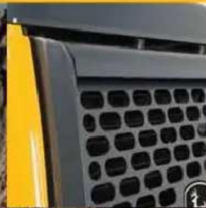
El capó del motor está construido en un material compuesto resiliente que resiste los choques y el daño. Las extensiones estándar de la parrilla añaden protección al extremo delantero.
