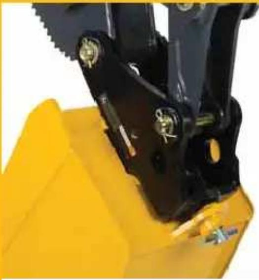
El acoplador en el gancho superior Worksite Pro™ permite cambiar rápida y fácilmente los cucharones con pasador único. Acepta cucharones de 30, 46 y 61 cm (12, 18 y 24 pulg) para servicio severo.
