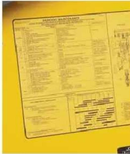
Las cómodas tablas de lubricación y mantenimiento periódico aseguran que nada se pase por alto. Los bujes sintéticos en el varillaje de la cargadora y el brazo extensible eliminan una gran cantidad de graseras.
