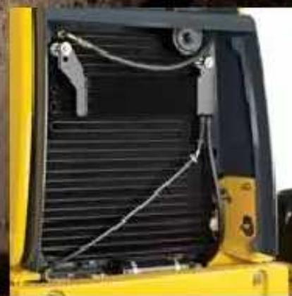
No más enfriadores del sistema hidráulico y transmisión superpuestos delante del radiador. Gracias al mejor flujo de aire, la velocidad del ventilador fue reducida para reducir la acumulación de basura y el ruido. Además, la limpieza es más fácil.
