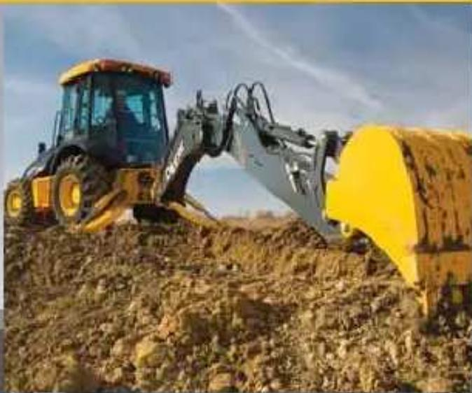
El brazo extensible agrega profundidad de excavación, alcance y capacidad. El diseño de caja exterior agarra objetos tales como losas de hormigón entre el cucharón y los dientes sujetadores mientras se extiende o retrae. Para cargar más fácilmente los camiones.
