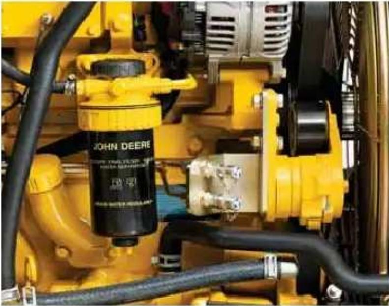
Los filtros verticales atornillables del motor, transmisión y sistema hidráulico, y los filtros de combustible de desconexión rápida facilitan los cambios sin que ocurran derrames.
