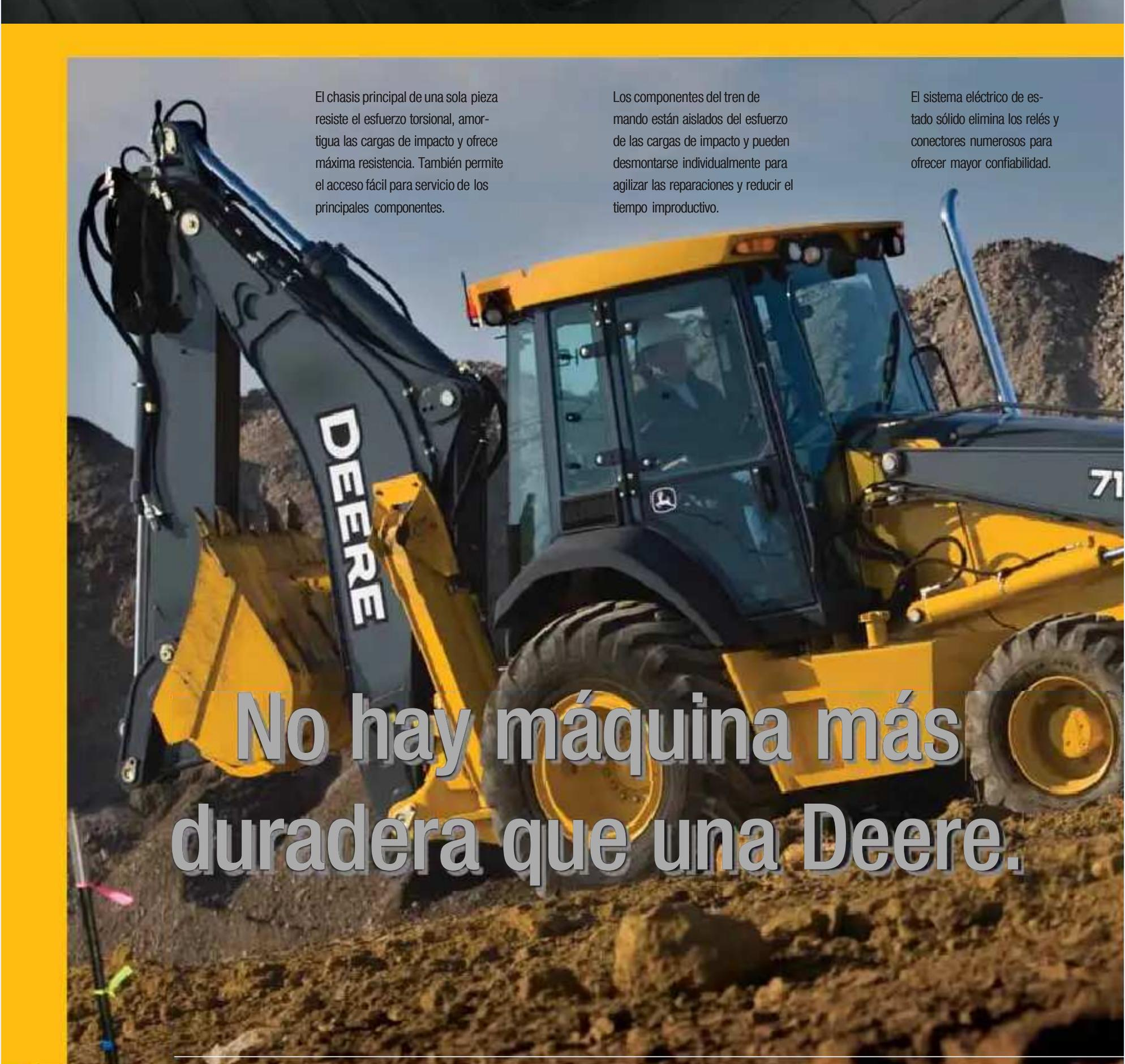
El chasis principal de una sola pieza resiste el esfuerzo torsional, amortigua las cargas de impacto y ofrece máxima resistencia. También permite el acceso fácil para servicio de los principales componentes.
