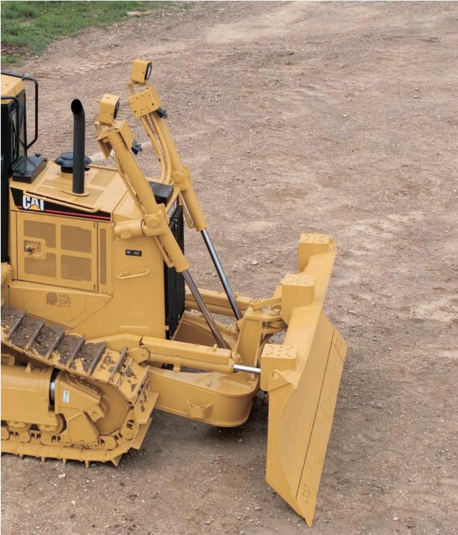
**Hojas Cat®.** Todas las hojas tienen un diseño fuerte de sección en caja que resiste los movimientos de torsión y agrietamiento. Las hojas están hechas de acero DH-2™ Cat con alta resistencia a la tracción que soporta las aplicaciones más rigurosas. Vertedera de construcción pesada y cuchillas y cantoneras endurecidas empernadas que confieren resistencia y durabilidad.
