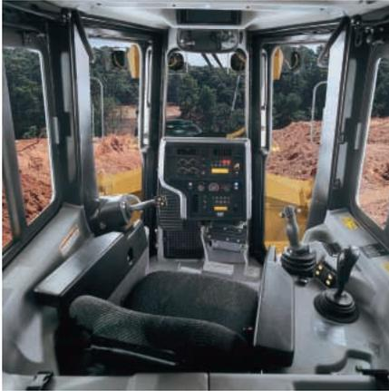
**Sistema Monitor Caterpillar.** El D6R III dispone de un sistema monitor flexible que se actualiza fácilmente por medio de software de programación. A medida que la tecnología va cambiando y se dispone de software y sistemas electrónicos nuevos, este sistema monitor actualizado permitirá actualizar la máquina con facilidad y aprovechará las ventajas de las mejoras.
