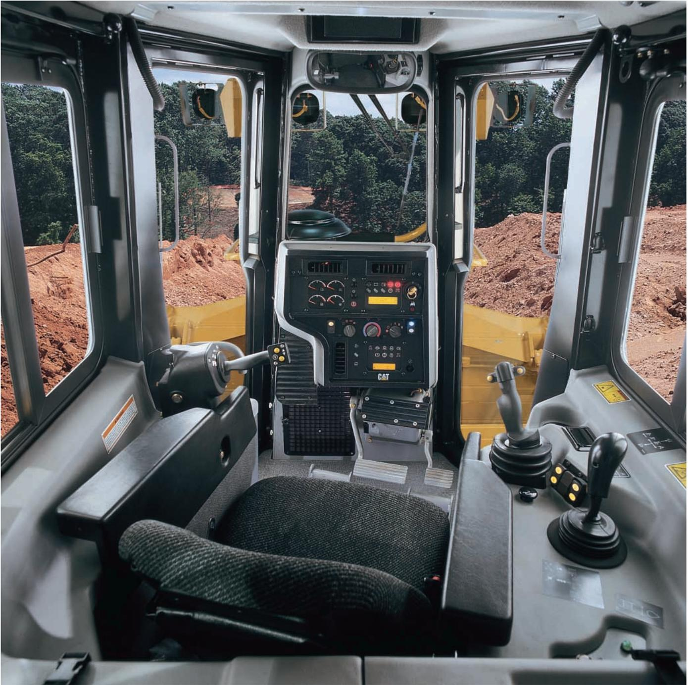
**Cabina.** Cabina a presión de montaje aislado que reduce el ruido y las vibraciones y aumenta la comodidad del operador. La cabina viene precableada para instalar una radio de 12 ó 24 voltios y está equipada con dos altavoces, una antena y montaje para radio empotrado en el forro del techo.
