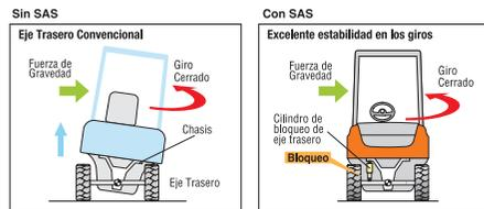
Una computadora incorporada monitorea el movimiento del montacargas y, si es necesario, bloquea el eje trasero para incrementar la estabilidad, como en el caso de giros del vehículo.
