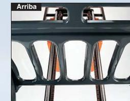
La rejilla protectora superior, el mástil y el panel de instrumentos han sido diseñados para proporcionar excelente visibilidad del extremo de las horquillas a las alturas más frecuentemente usadas.
