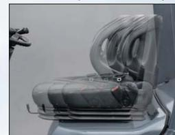
El asiento ORS puede ser ajustado 150 mm hacia delante o hacia atrás para proporcionar comodidad y soporte a operadores de diversas estaturas. ORS\*: sistema de restricción de operador
