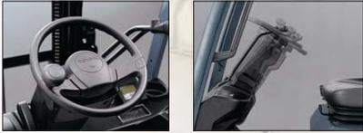
El volante de diámetro pequeño se une al sistema de dirección completamente hidráulico para proporcionar excelente maniobrabilidad. La columna de dirección proporciona un ajuste continuo que se adapta a un amplio rango de preferencias del operador.
