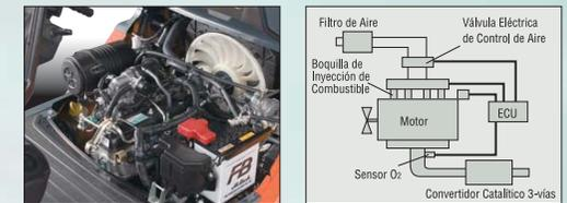
Control electrónico es utilizado en el motor 4Y para regular el sistema de inyección de combustible y encendido. Combinado con el Sistema de Conversión Catalítica 3-vías, filtra el monóxido de carbono (CO), hidrocarburo (HC) y óxidos de nitrógeno (NOx).
