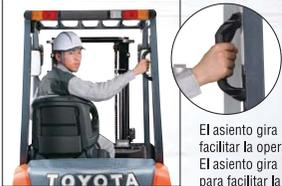
El asiento gira hacia la derecha para facilitar la operación en reverso. El asiento gira hacia la izquierda para facilitar la entrada y salida del montacargas.
