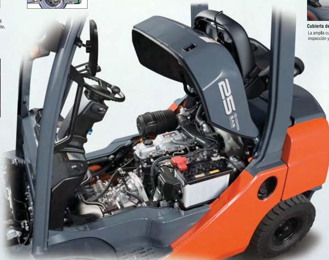
Facilidad de servicio contribuye a aumentar la confiabilidad del montacargas y a extender su vida de servicio útil. La Serie 8 ha sido diseñada de manera tal que cualquiera pueda inspeccionarla fácilmente. Si se necesita servicio, el fácil acceso reduce los tiempos de parada.
