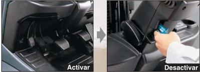
El operador simplemente empuja el pedal de freno de estacionamiento para activarlo sin cambiar la posición de operación. Una palanca convenientemente localizada permite desactivarlo.
