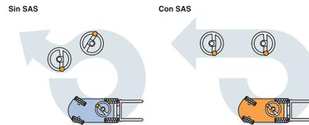
Esta función garantiza que la posición de la rueda de dirección siempre corresponda con la posición de la rueda trasera.
