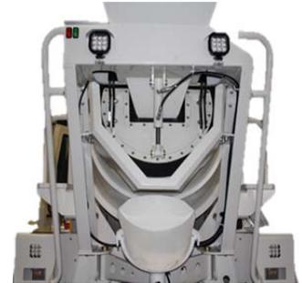
Incorpora Tapa hidráulica completa, cuentalitros, luces leds para trabajo y desplazamiento, y luces de seguridad con código de color para indicar el sentido de la marcha dentro del túnel, luz de posición y de intermitencia incorporadas en un mismo dispositivo lumínico.
