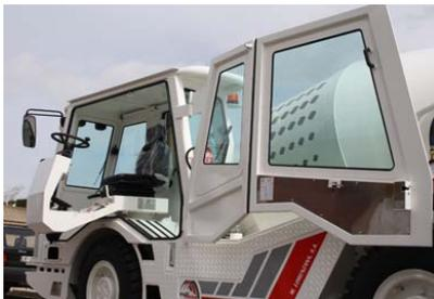
Una cabina más amplia y de gran **visibilidad 360°** que permite girar el puesto de conducción para invertir el sentido de la marcha y que facilita la labor del operario.
