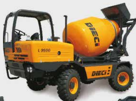
L 3500 112 hp capacidad 3,5 m 3 rendimiento 2,50 m 3
