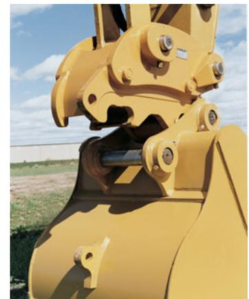
*Acoplador rápido con sujetapasador*
