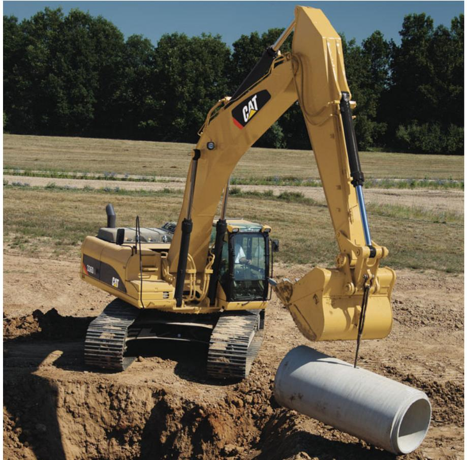
**Válvula hidráulica auxiliar.** La 336D cuenta con una válvula auxiliar de forma estándar. Los circuitos de control están disponibles como accesorios, lo que permite la operación de herramientas de presión alta y media, como cizallas, garfios, martillos, pulverizadores, multiprocesadores y compactadores de placa vibratoria.
