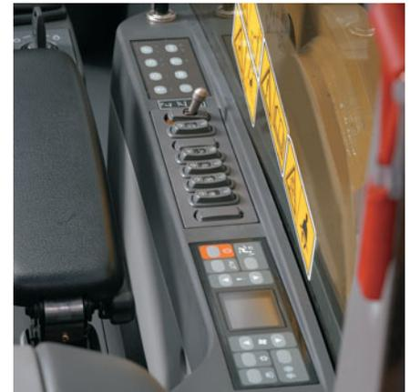
**Consola.** Las consolas tienen un nuevo diseño simple y funcional que reduce la fatiga del operador, ofrece fácil operación de los interruptores y proporciona excelente visibilidad. Ambas consolas poseen apoyabrazos integrados, con ajustes de altura.
