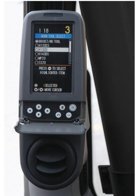
**Sistema de control de la herramienta.** El sistema de control de la herramienta optativo maximiza la productividad de la herramienta al configurar el flujo hidráulico, la presión y los controles del operador para adaptarse a una herramienta específica. La versatilidad del sistema permite el uso de una amplia variedad de herramientas.
