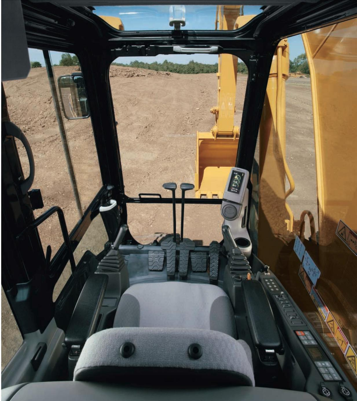
**Puesto del operador.** La estación de trabajo es amplia, silenciosa y cómoda, asegurando una alta productividad durante una jornada laboral larga. Los interruptores del aire acondicionado y del accesorio están ubicados convenientemente en la pared lateral derecha y el interruptor de arranque con llave y el selector de aceleración están en la consola del lado derecho. El monitor es fácil de ver y aumenta la visibilidad al máximo.
