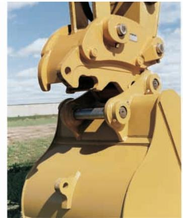
*Sujetador del pasador más sujetador del pasador hidráulico*
