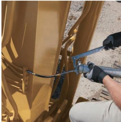
**Puntos de lubricación.** Un bloque de lubricación de concentración remota en la pluma suministra grasa a ubicaciones de difícil acceso en la parte delantera.
