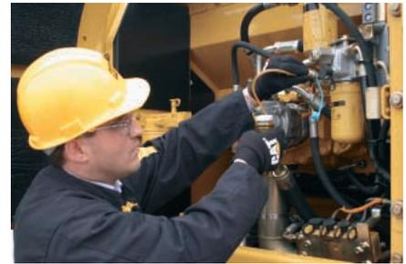
**Diagnóstico y sistema monitor.** La 330D L tiene válvulas de muestreo S•O•S™ para el aceite hidráulico, el aceite del motor y el refrigerante, y válvulas para pruebas hidráulicas. En la cabina se encuentra una conexión de prueba para la herramienta de servicio del Técnico Electrónico (ET Cat).
