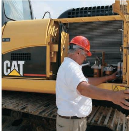
**Compartimiento del radiador.** La puerta de servicio trasera izquierda permite un fácil acceso al radiador, el enfriador de aceite y al posenfriador aire a aire. Un tanque de reserva y un grifo de drenaje están conectados al radiador para facilitar el mantenimiento.
