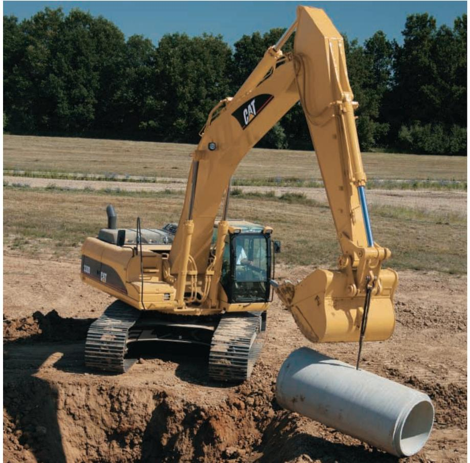
**Válvula hidráulica auxiliar.** La válvula auxiliar es estándar en la 330D L. Los circuitos de control están disponibles como accesorios, permitiendo la operación de herramientas de presión alta y mediana, como cizallas, garfios, martillos, pulverizadores, multiprocesadores y compactadores de placas vibratorias.
