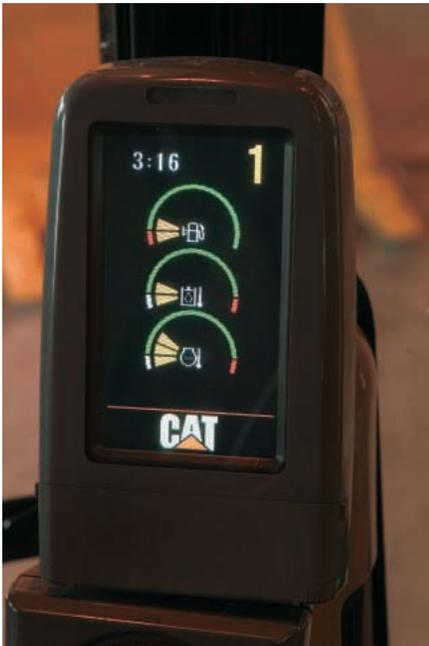
**Monitor.** El monitor es una Pantalla de Cristal Líquido (LCD) de 400x234 píxeles que muestra gráficos a todo color. El ángulo del monitor puede ajustarse para minimizar el reflejo del sol, y puede mostrar la información en 27 idiomas diferentes.
