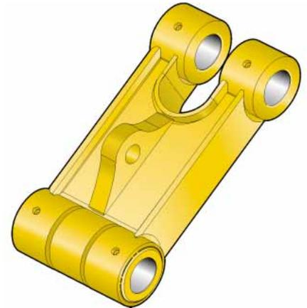
**Varillaje del cucharón.** El nuevo eslabón de potencia prolonga la durabilidad, aumenta la capacidad de levantamiento de la máquina en posiciones de levantamiento clave y es más fácil de usar comparado con el diseño anterior de cáncamo de levantamiento.
