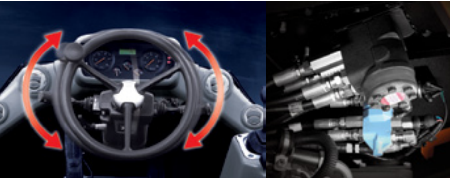
Dirección hidráulica El nuevo diseño del sistema de dirección garantiza un control uniforme aun con bajas revoluciones del motor. - Válvula de control de la dirección.
