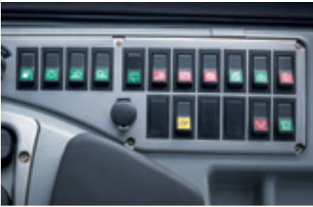
Interruptores Panel de interruptores ergonómico y adaptado a los movimientos naturales del cuerpo, que permite una operación muy cómoda. Los interruptores extra permiten instalar accesorios eléctricos externos.
