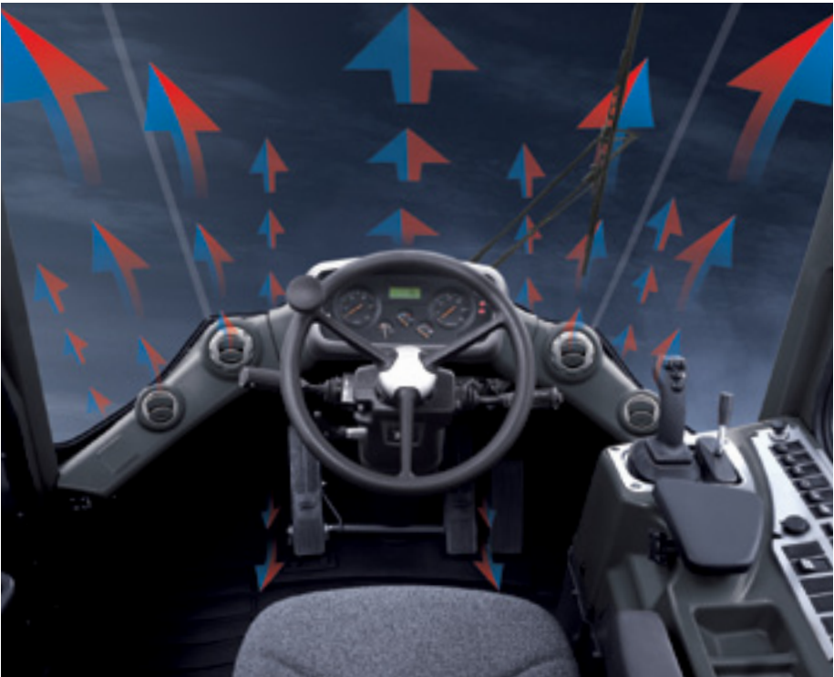
Aire acondicionado y desempañador Cabina con filtrado doble de aire y ductos de aire bien ubicados, con controles sensibles y función de recirculación. Las comodidades son idénticas a las de un automóvil.
