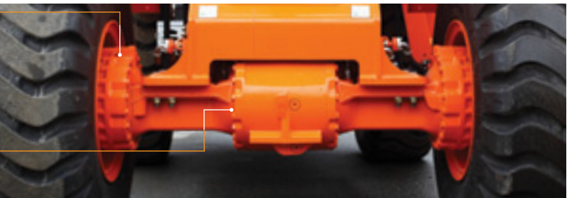
Mayor durabilidad del eje Los discos de freno se han reubicado a la parte trasera del engranaje de reducción, donde la velocidad de rotación es menor. Como resultado, quedan expuestos a menos rpm, disminuye la generación de calor y su vida útil aumenta en gran medida. Se ha agregado un regulador automático del huelgo de los discos, por lo que este se mantiene en el nivel óptimo a medida que los discos se gastan. Esto evita que el freno responda de manera tardía. Otra función útil es la posibilidad de medir fácilmente el desgaste de los discos de freno sin desarmar el cubo.
