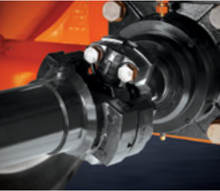
Eje de transmisión Una tapa de protección resguarda al sello de aceite del polvo, los cuerpos extraños y el desgaste prematuro.
