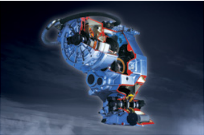
Transmisión completamente automática La transmisión electrónica es particularmente suave y las relaciones entre engranajes son ideales para lograr el valor óptimo de revoluciones. Esto aporta comodidad y, a la vez, brinda una excelente tracción en cualquier situación de trabajo. Los controles electrónicos integrados mejoran la productividad y la durabilidad.
