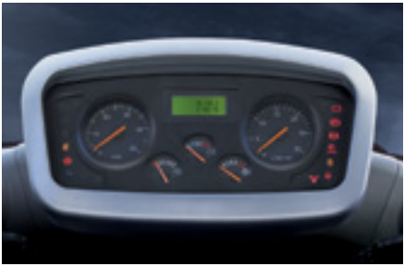
Panel de control central Este compacto panel tiene un diseño ergonómico y permite que el operador supervise el estado y las luces de advertencia de un vistazo.
