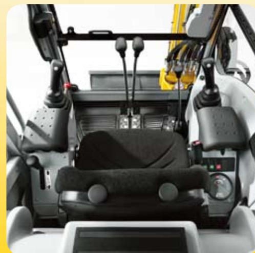
1 Acceso amplio y cabina espaciosa que permite ser desmontada con pocos movimientos. Sin la cabina también se cuenta con todas las funciones de control y de la máquina.
