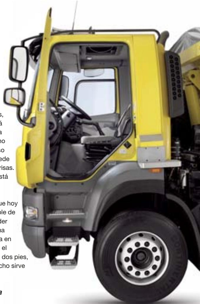
**El peldaño de acceso central está fijado al chasis y el peldaño inferior se fija de forma flexible para reducir el riesgo a daños.**
