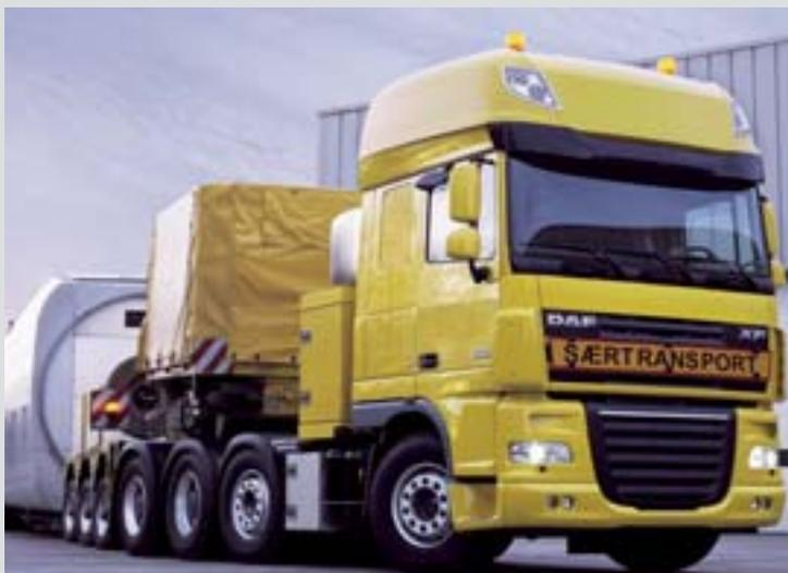
El nuevo FTM de la gama XF105 se ofrece con el motor PACCAR MX de 12,9 litros de seis cilindros. Se puede elegir entre potencias desde 300 kW (410 CV) hasta 375 kW (510 CV), con pares de 2.000 hasta 2.500 Nm, disponible en un amplio campo de revoluciones de 1.000 a 1.500 rpm. Por un precio adicional, está disponible el cambio automático AS-Tronic. En el FTM, según la versión, puede montarse un cambio de dieciséis marchas, desarrollado específicamente para aplicaciones pesadas.
